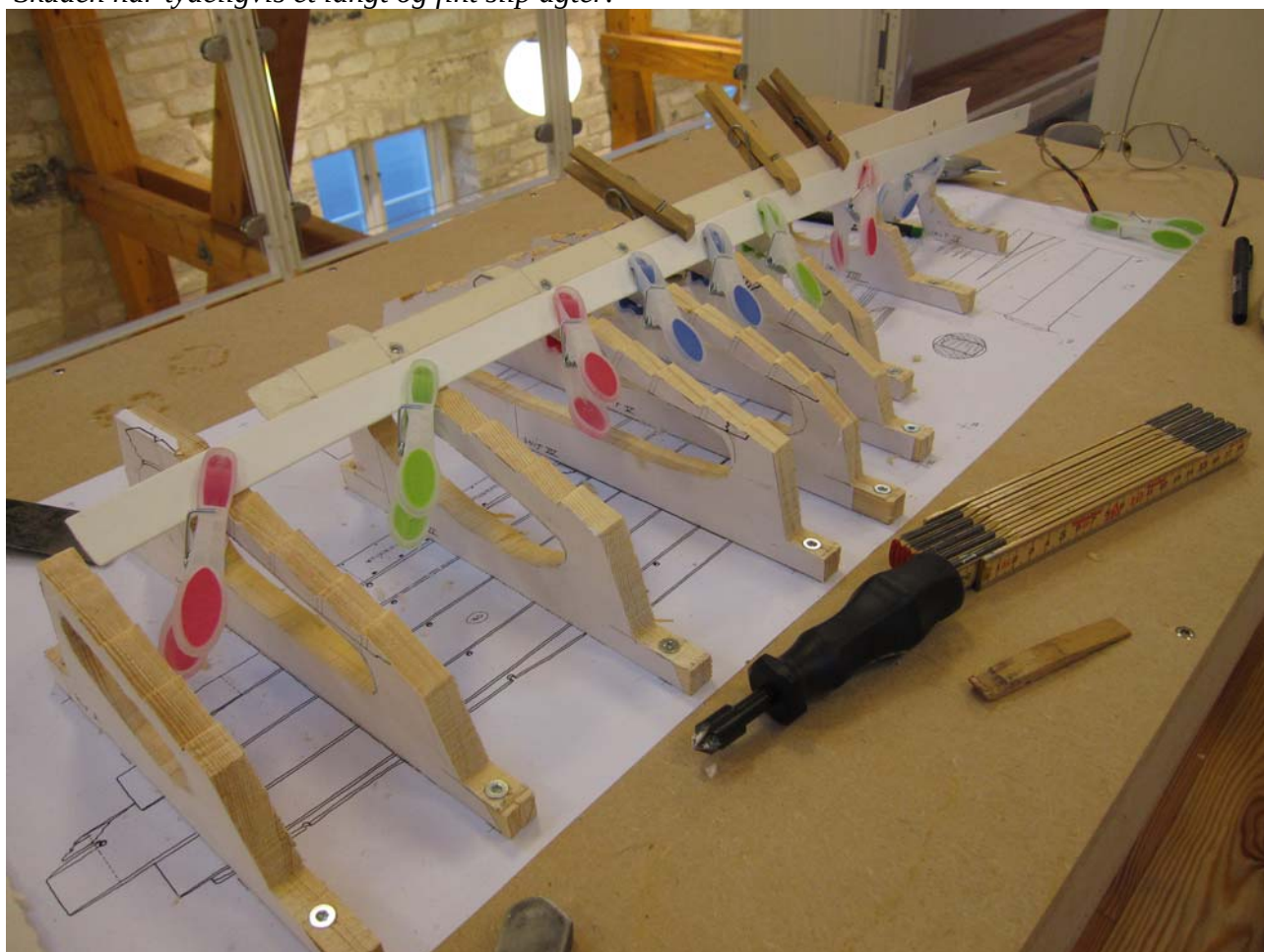
Rien til næste bord bekræfter en skrogbygning, der skærer agter og bærer længere fremme i skibet.
