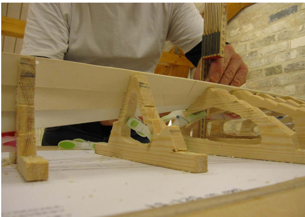
Hvor der på strandingspladsen i Klim blev målt ned til vragdelene, bliver de samme afstande i 1:10 nu målt op fra byggebeddingen til gendannelse af vragdelene.
