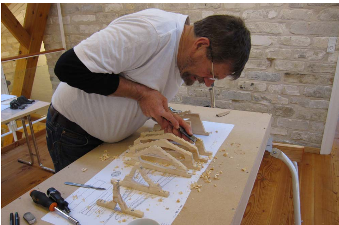
De mange tværsnit i agterskibets nederste vrugdel angiver skudens slip agter, da de kan forbindes hen over kølen, som desværre ikke er fundet. Her stikkes deres anlægsflader til efter at være skruet vinkelret på plads i forhold til opmålingens basislinie.
