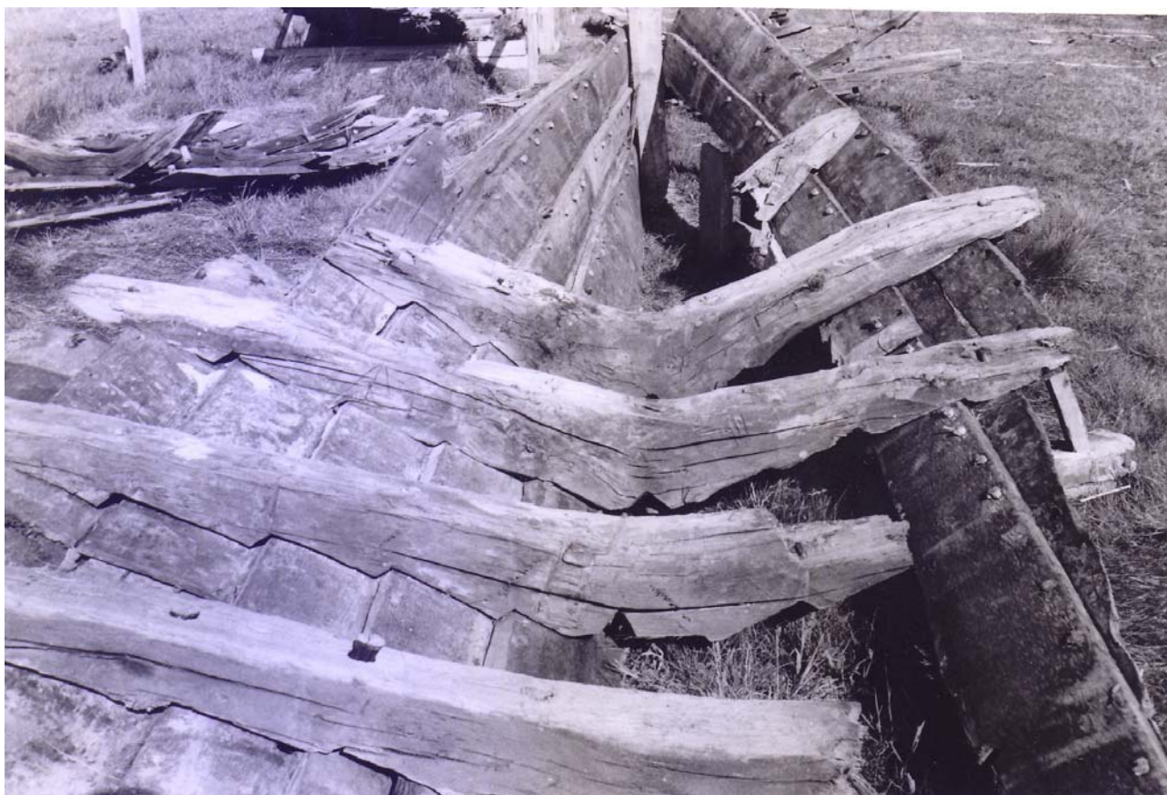
Her ses sandsporene i bundstokkene på Pedersbæks vrug.
