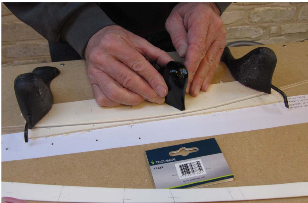
Trækstokken skubbes på plads med en hval.
