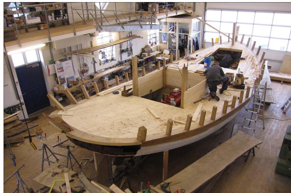
Foreningens første renovering – havbåden Nordvest fra 1962 – i det nye bådeværft. Foto: Kirsten Monrad Hansen.
