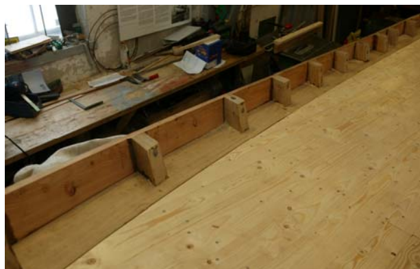
Der er lagt dæk af høvlede og pløjede brædder i Jammerbugt. Peter har sat mastekisten fast, og Freddy har lagt sidste hånd på fordækket. Først blev der lagt skandæk – der er den yderste del af dækket – af egetræ. Foto: Pipsen
