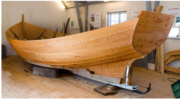
22. april 2008: »Elbo« har fået sin kølskinne og er sænket ned på gulvet til en mere bekvem arbejds højde.
