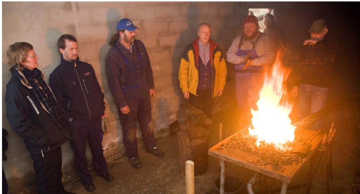
Spillavet, der også tæller en håndfuld smede, kom i aktion lørdag 29. marts, hvor der blev stillet en transportabel kulesse op i fiskepakhuset. Her blev der bøjet køljern og smedet beslag til »Elbo«.
