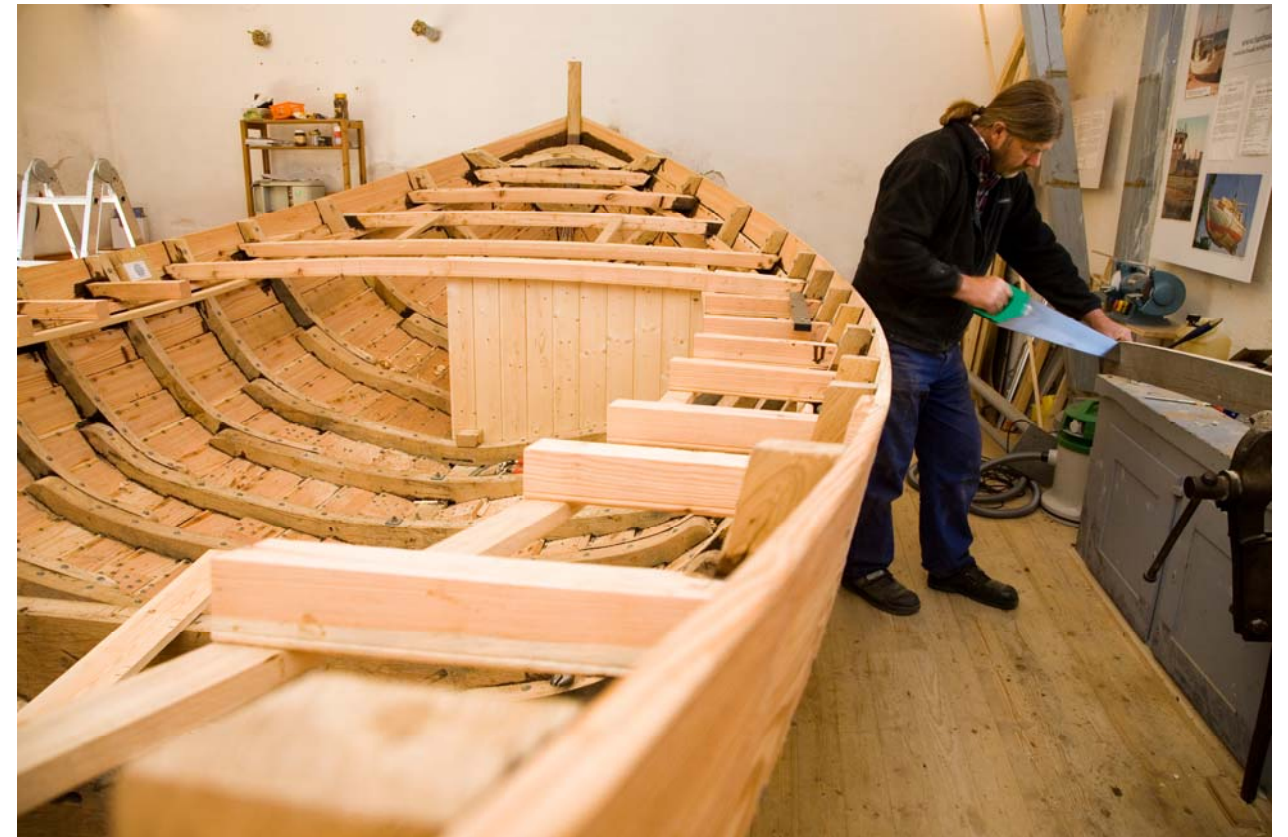
16. maj 2008: Dækket til den nye »Elbo« begynder at tage form, og Peter Bådebygger er ved at gøre klar til at kunne sætte skruetøjet til den 24 HK Buhk-motor i.
