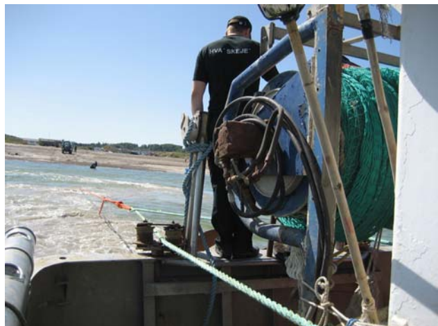
De første dage af juni blev der arbejdet med at spule wire og hovedblok fri, så blokken kunne hales i land af spillet.
