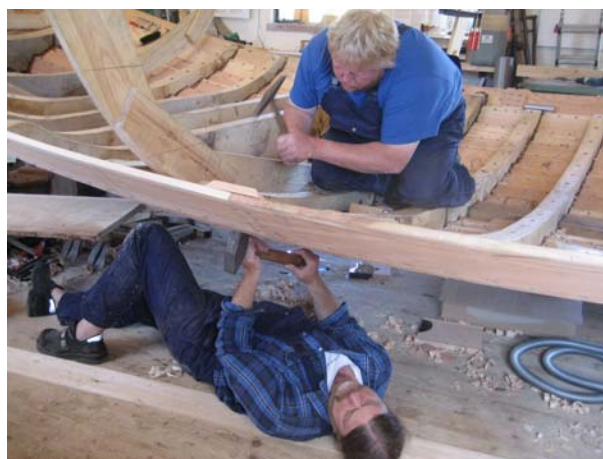
Klinkning af en bundstok på Jammerbugt. Peter holder imod, mens Freddy klinker. Foto: Pipsen
