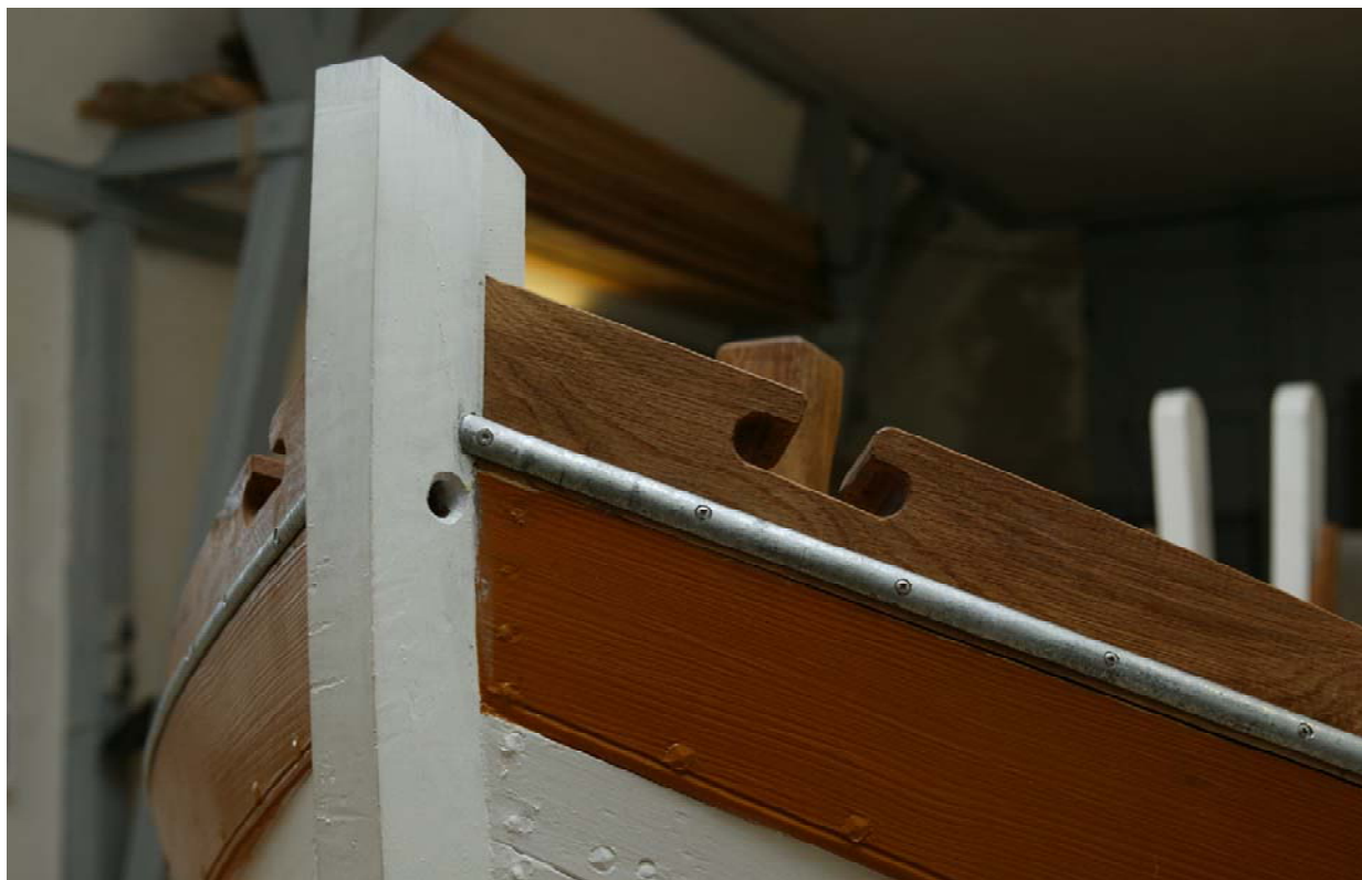
Der er nu kommet svinerygge – det fine træstykke oven på lønningen op mod forstævnen – på Elbo.
