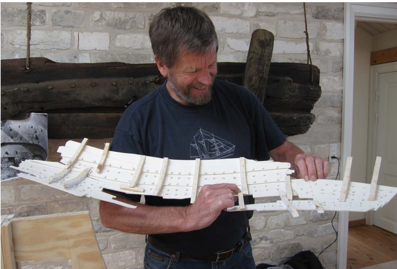
Forenden holdes på for at vurdere, hvordan den kan passe ind i såvel spantesystemet som bordforløbet.
