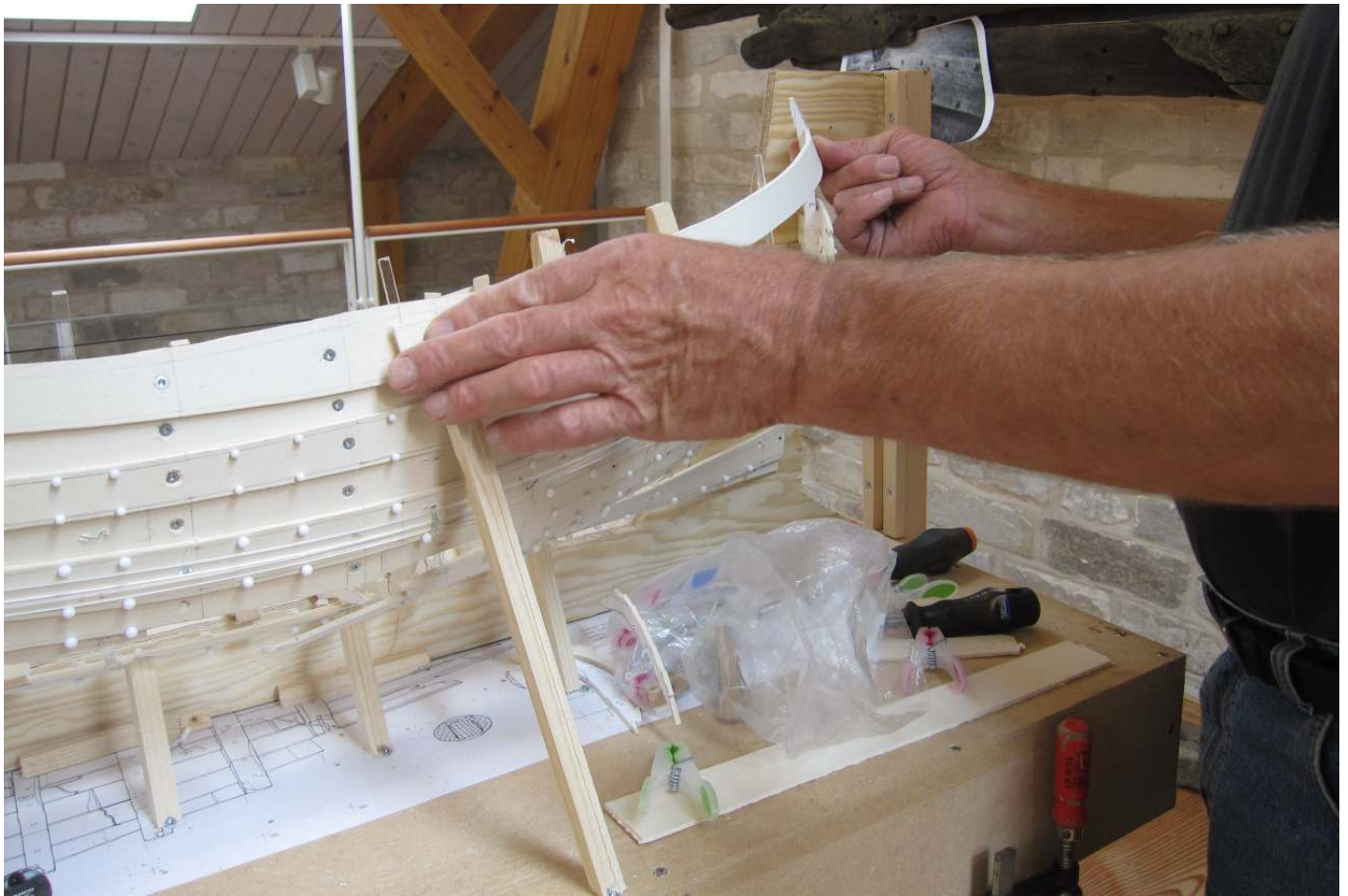
Der afsløres megen potentiel facon i det øverste agterskib allerede ved at bukke rien på plads.
