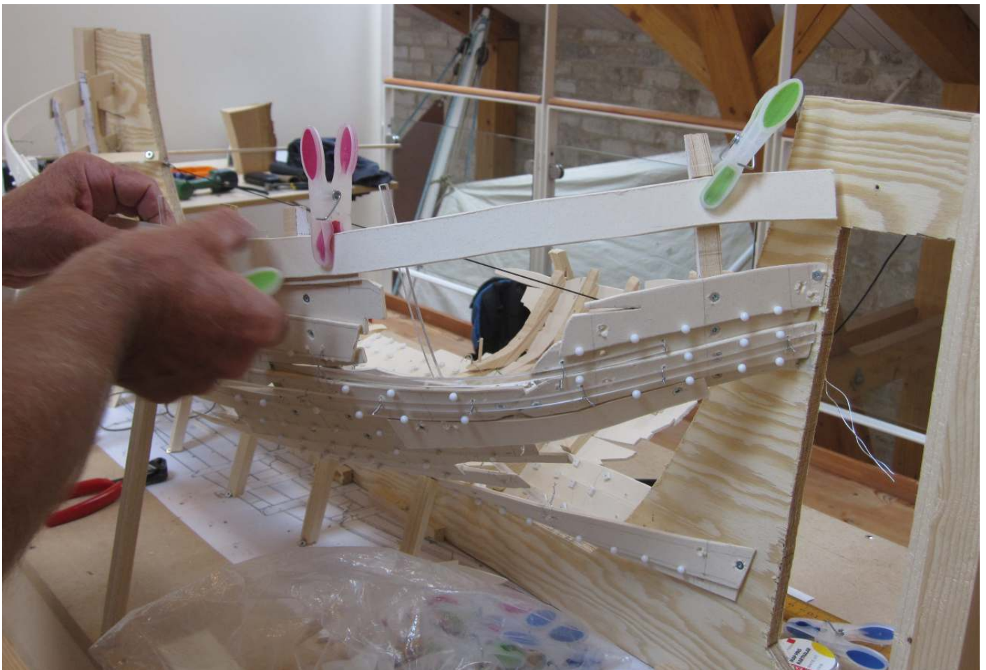
Den groft tilskårne model hæftes med klemmer. Agter angiver spanteenderne endnu en bordgang over det gennemgående øverste bord.
