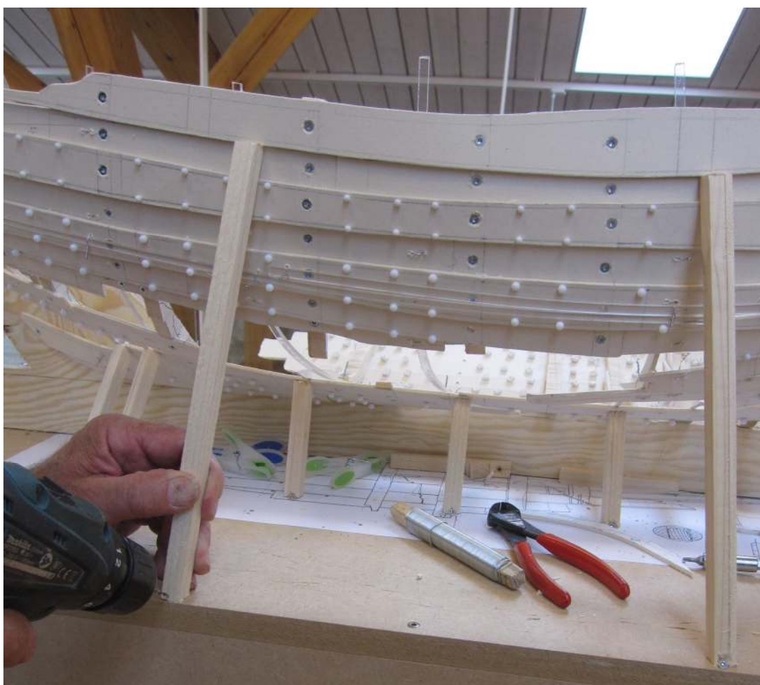
For at opretholde linjerne i skibssiden som helhed sættes også en understøtning længere forude.
