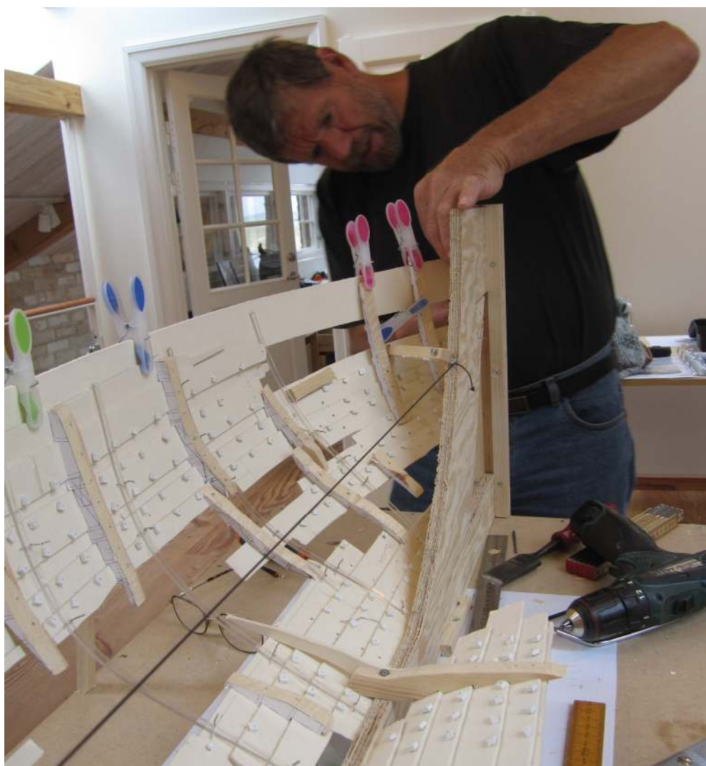
Den tilskårne model skrues fast til stævnen.
