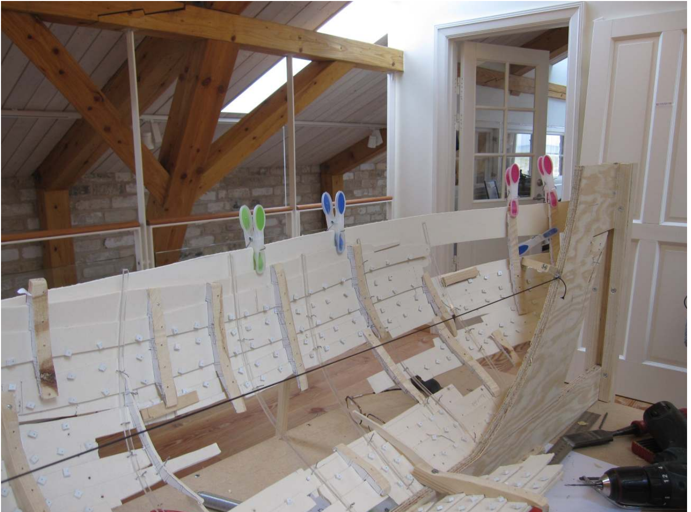
Et groft tilskåret ri af pap hæftes til spanteenderne med klemmer.
