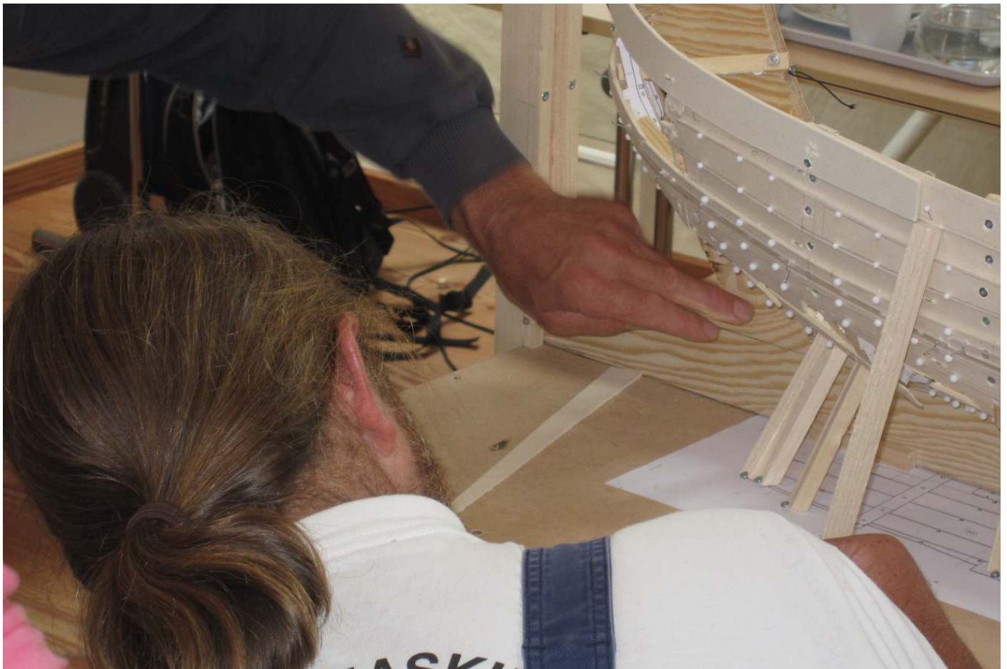
Fokus rettes direkte mod det sted, der i sidste instans ser ud til at være styrende for de vanskeligheder, bordforløbet stikker i.
