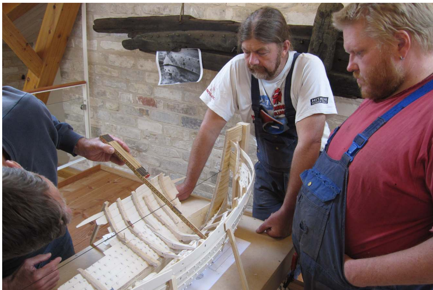
Mortens måling viser imidlertid, at det er den ikke, og Peter forklarer, at når der som i bagbord side mangler nogle planker, så snyder det øjet og siden ser højere ud, end bundrejsningen fysisk set er.
