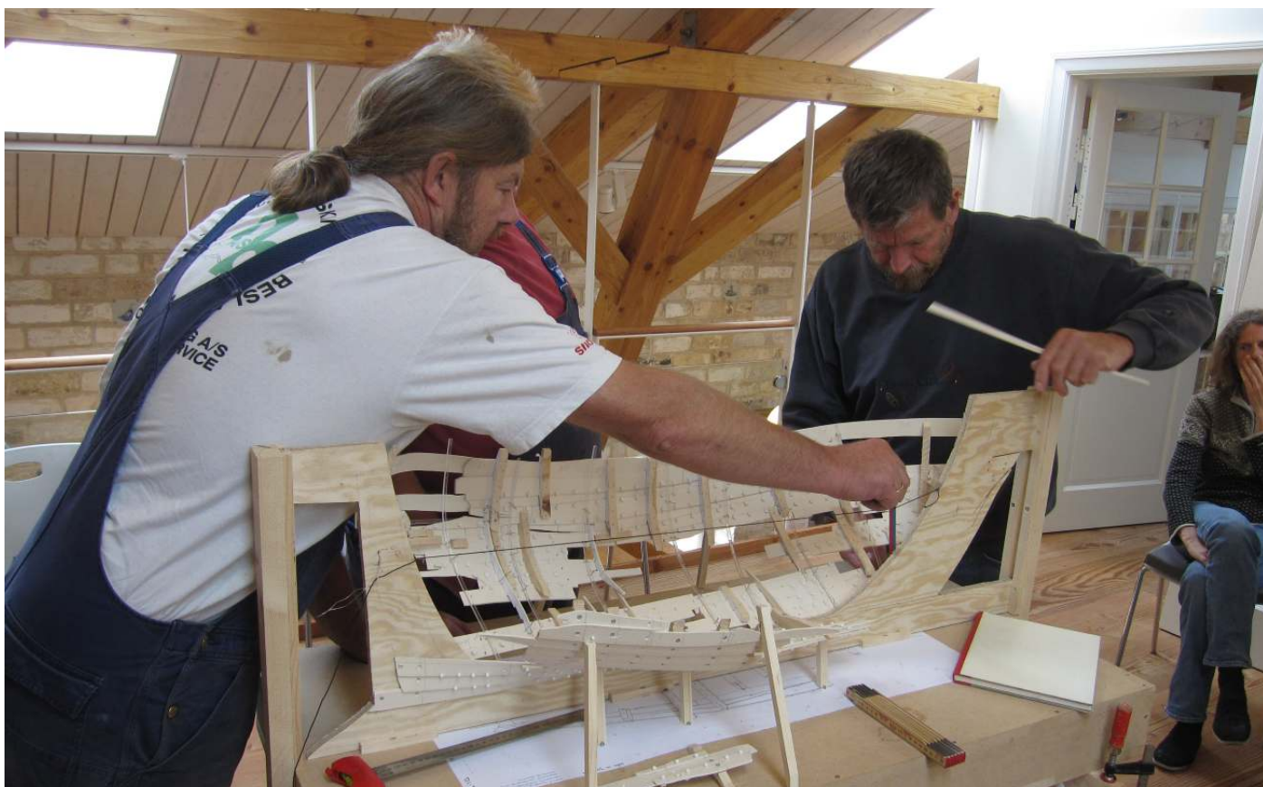
Blyanten peger på de bordgange, Peter mener, kan have været skarpere. Morten holder et papstykke til at prøve S-kurven af med.
