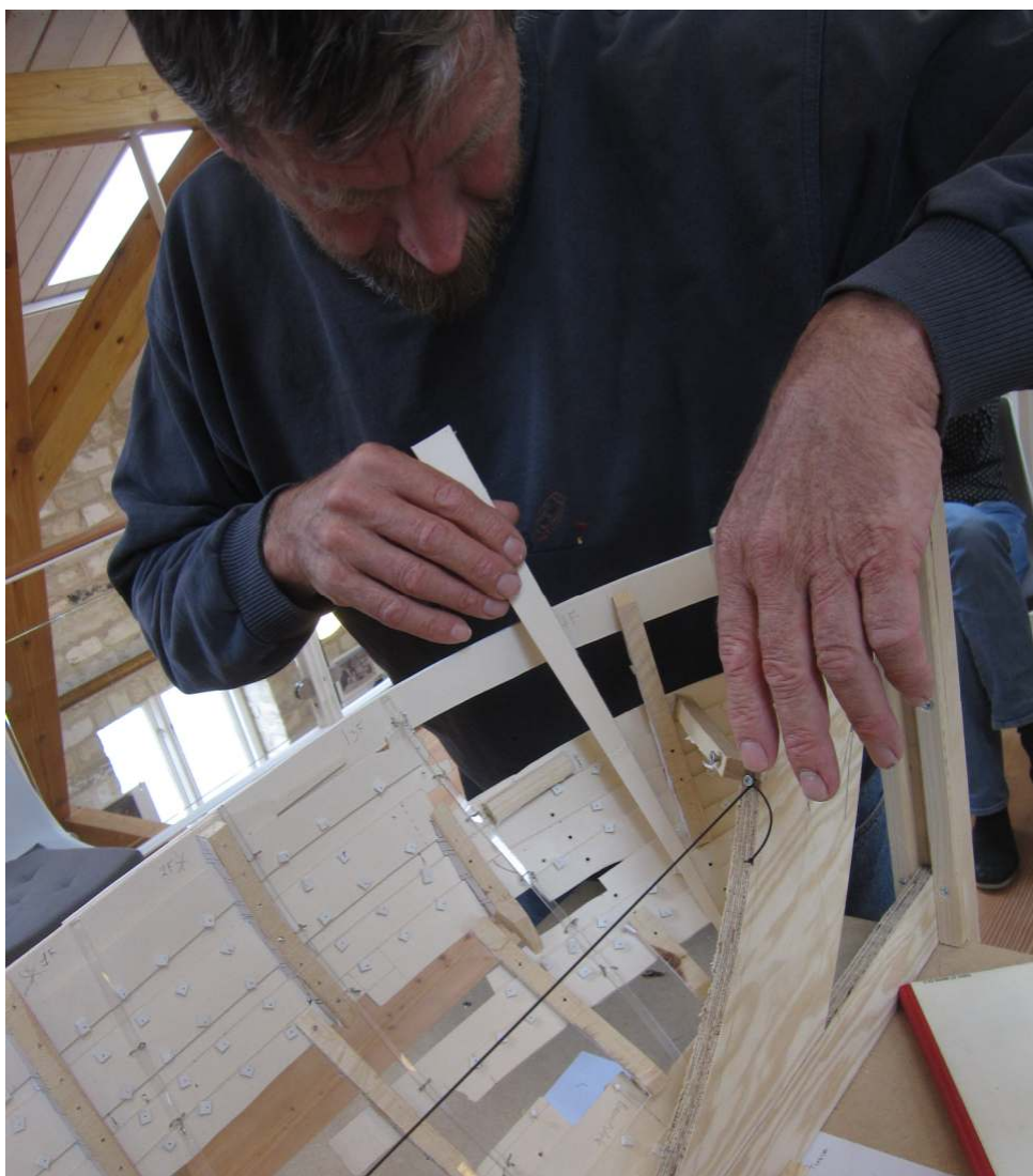
Blyanten peger på de bordgange, Peter mener, kan have været skarpere. Morten holder et papstykke til at prøve S-kurven af med.
