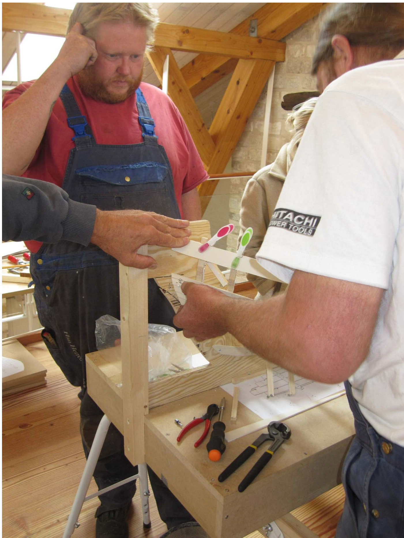
Morten og Freddy er bekymrede for, hvor langt det går – øges eller slækkes spændingerne i skrogbygningen. Peters vurdering – ud fra den modstand hans hænder mærker – er, at spændingerne aftager, selvom det ser modsat ud.
