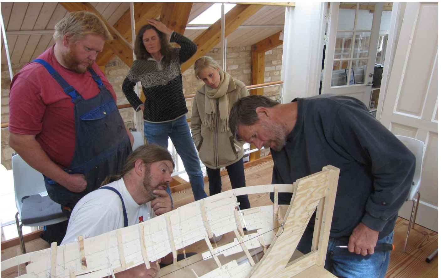
Morten bekræfter, at nu kan han se, at det er her, den er gal. Den sammenhængende plankeskal, der når stævnen i forskibets fribord giver simpelthen ikke plads til de fem første bords hensigtsmæssige forløb op til stævnen.
