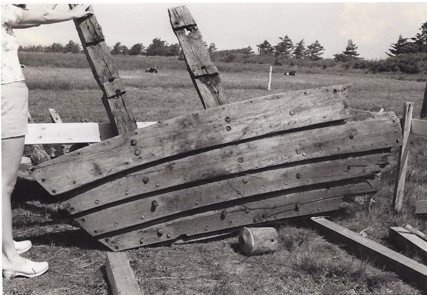
Set udvendig fra havde bordskallens fire øverste bord en grov, men relativt jævn konveks kurve. På grund af forskelligt træ kan udtørringen også ændre de enkelte bords længde og bredde under udtørringen på land. Som det ses på billedet er det femte bord fra oven flækket og først samlet med sin modpart i juni 1976.
