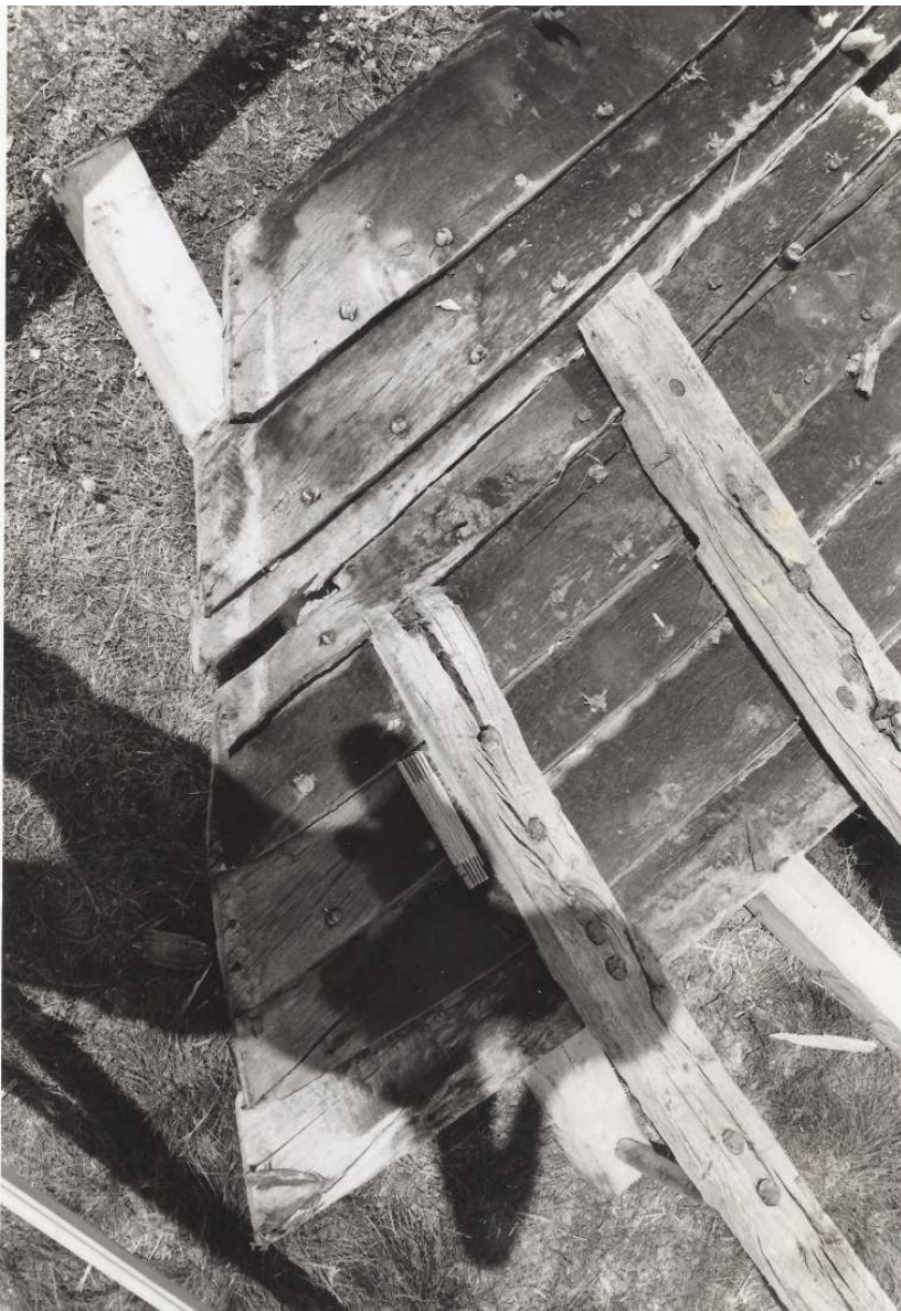
Der er tydelige forskydninger mellem bordenes længde, da de forsøges samlet før opmålingen. Dette foto dokumenterer problemet, men der skal mere til at forklare, hvorfor det ser sådan ud.
