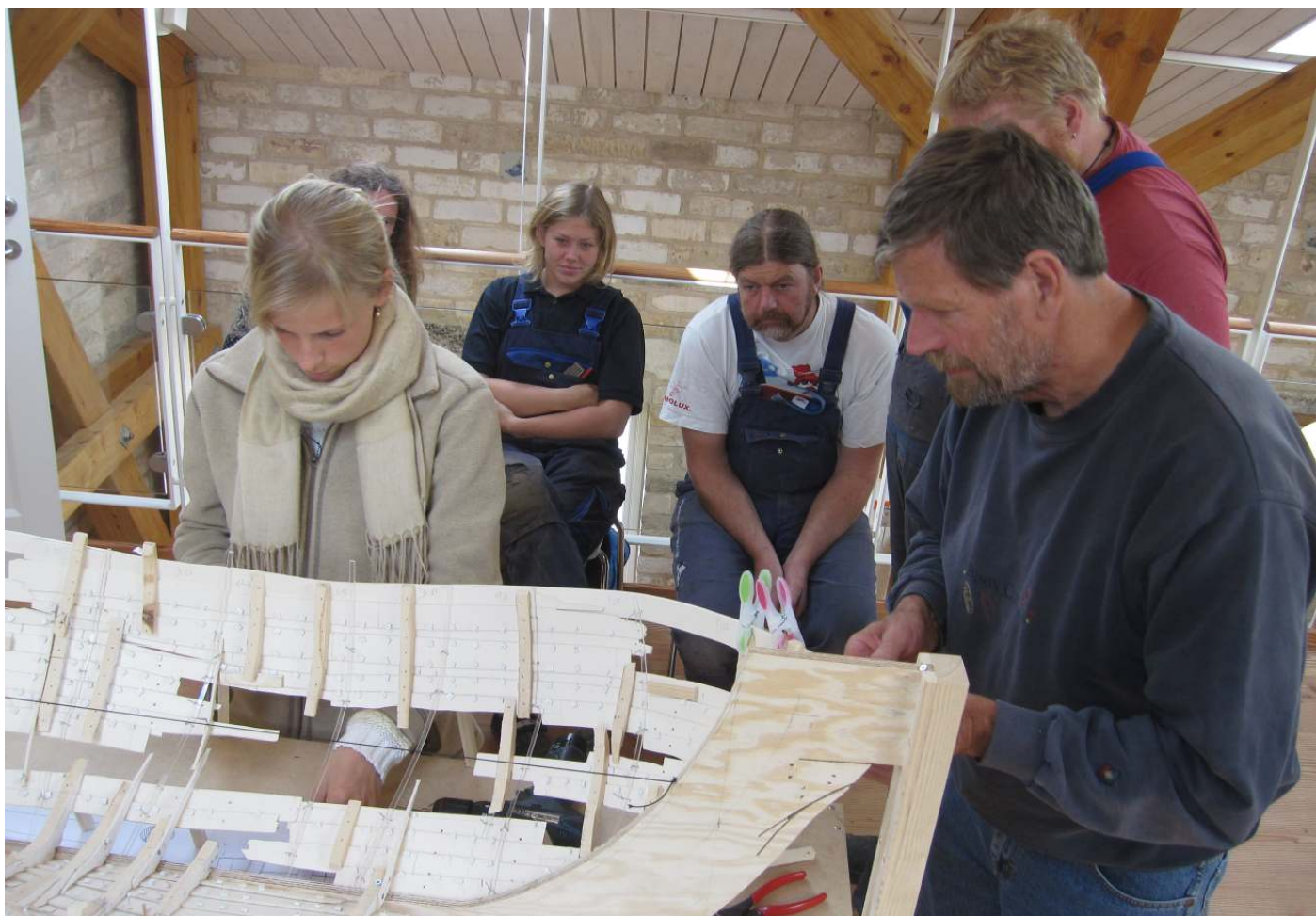
Det er stadig ikke godt nok, så Morten og Mathilde gør det forsøg at justere stiverne ind efter det nye forskib, så bordene kommer løbende rigtigt frem mod stævnen.
