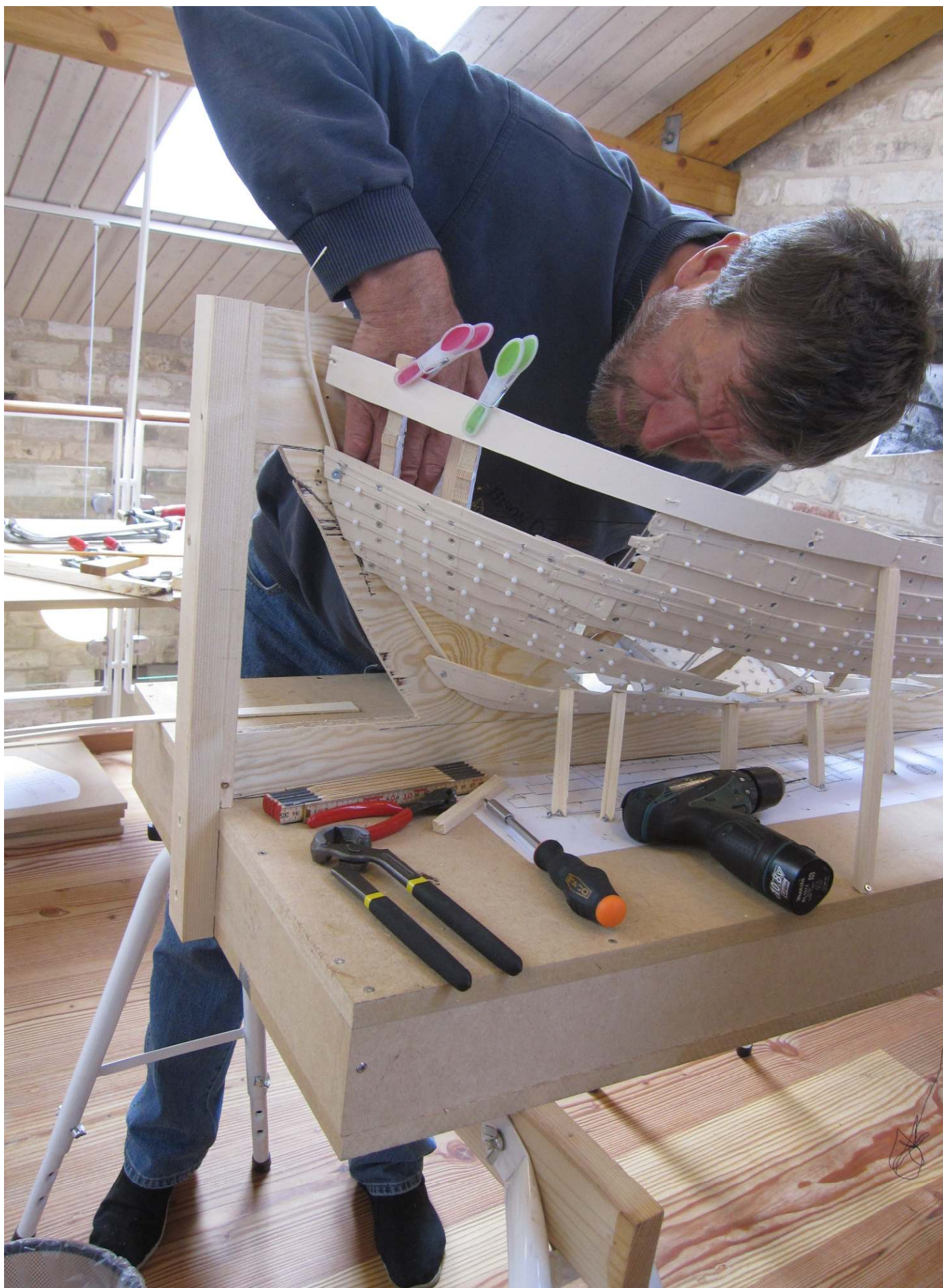
Morten forsøger at finde en linje i spundingens forløb indefra, men udefra afviger afslutningen på det nederste bord i den øvre bordskal.
