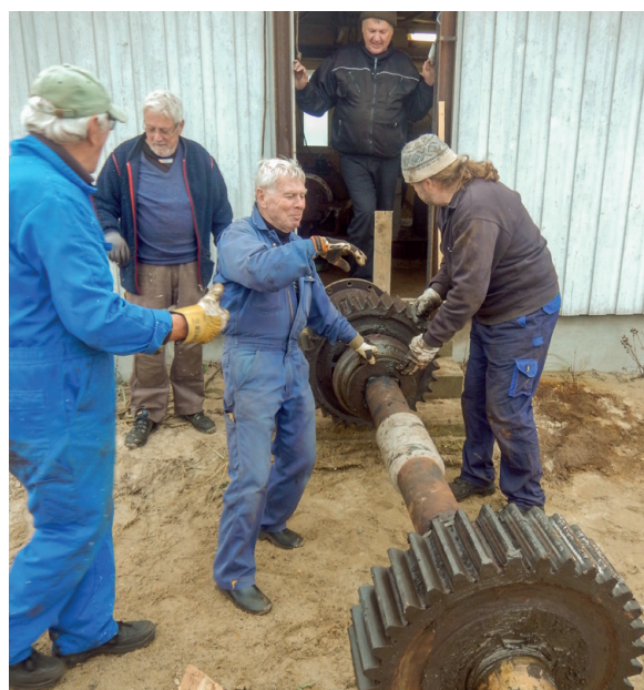
Spillets aksel er kommet ud af spilhuset. Foto: Karsten Bindslev
