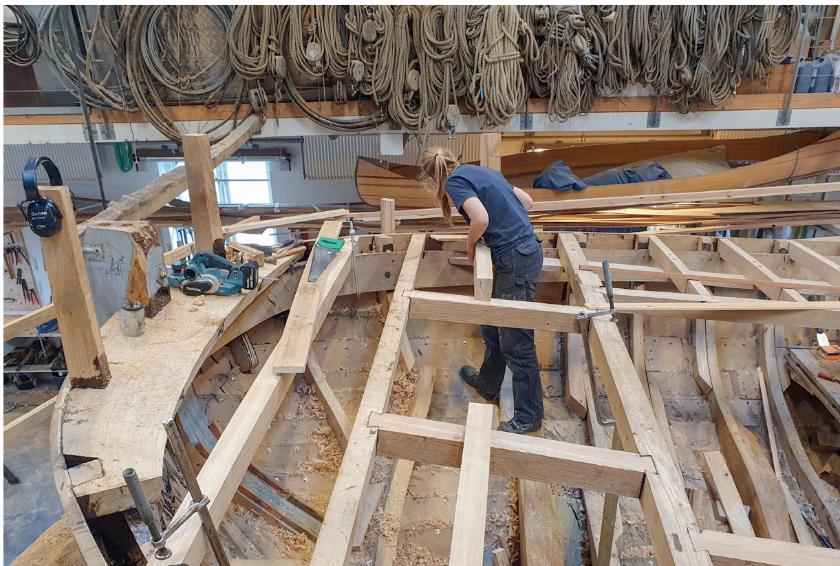
Anika i gang med at lave stikbjælker ved styrhullet. Foto: Pipsen
