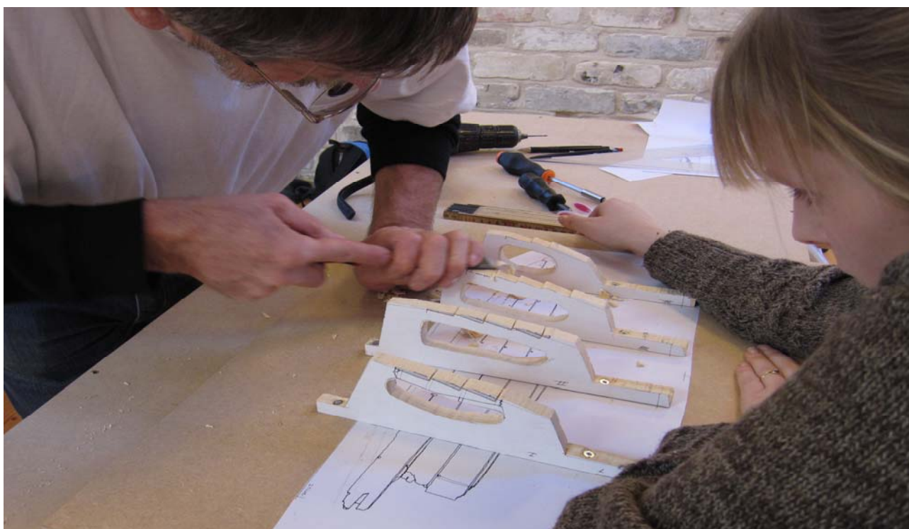
Spantemodellerne er skruet fast på byggebeddingen, hvorefter anlægsfladerne stikkes til.
