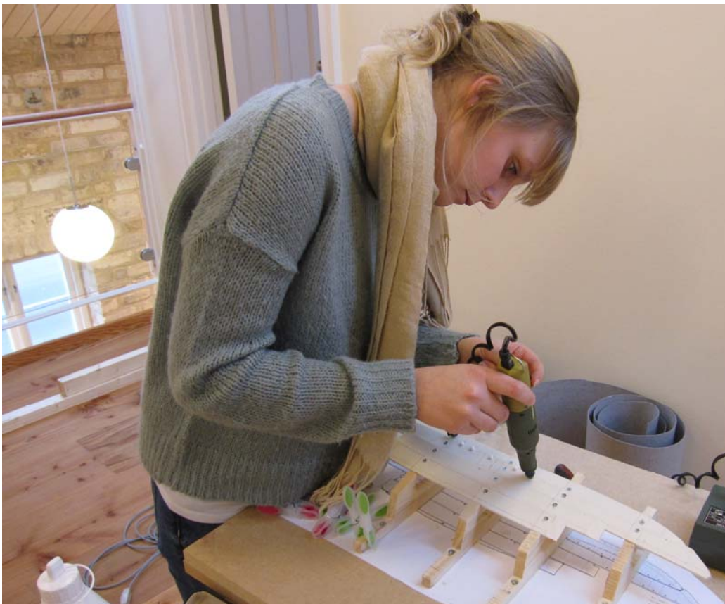
Der bores for til nitning med knappenåle.
