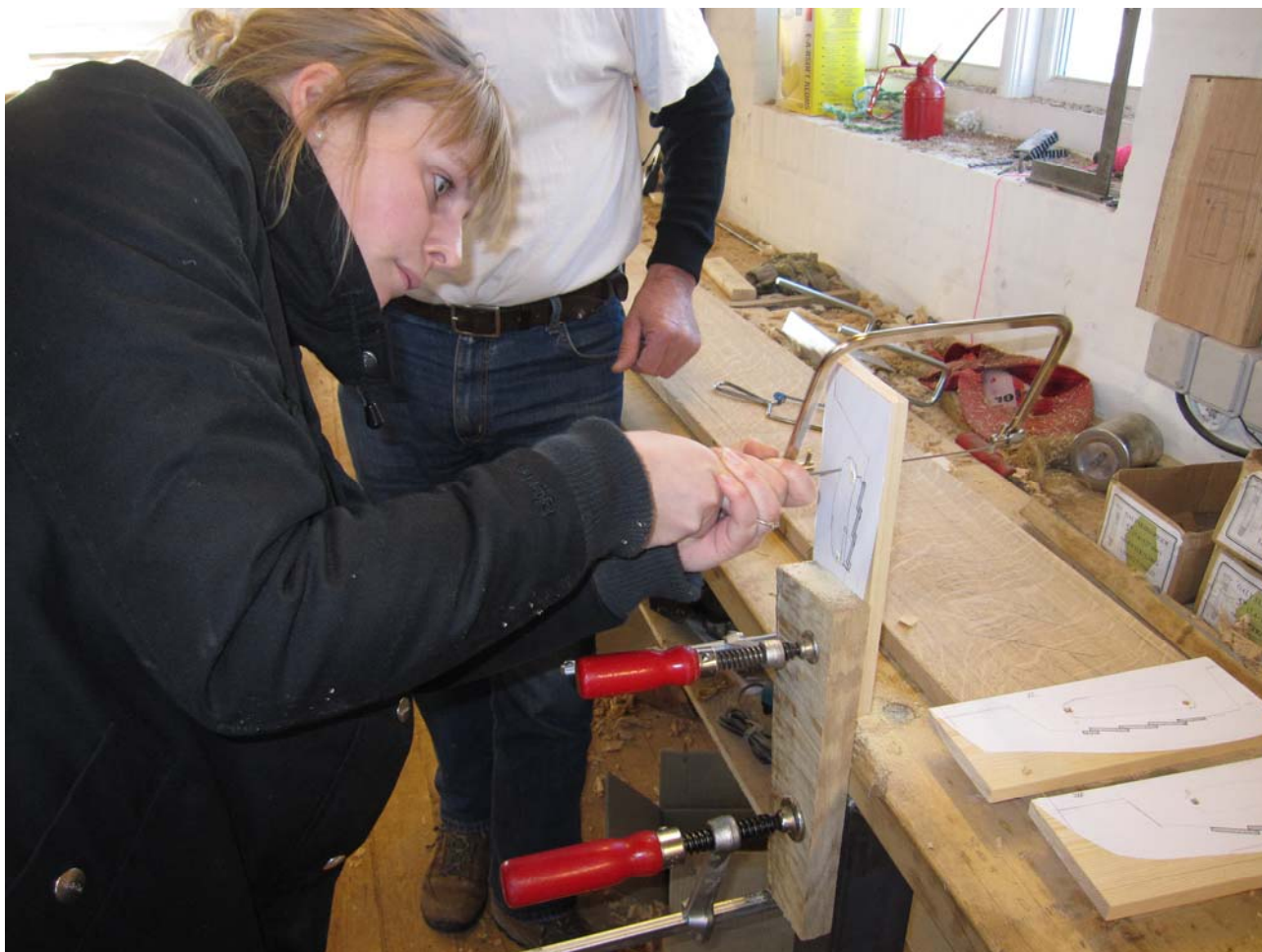
Spanterne saves så tæt til stregen, at de kan stikkes efter med et stemmejern.
