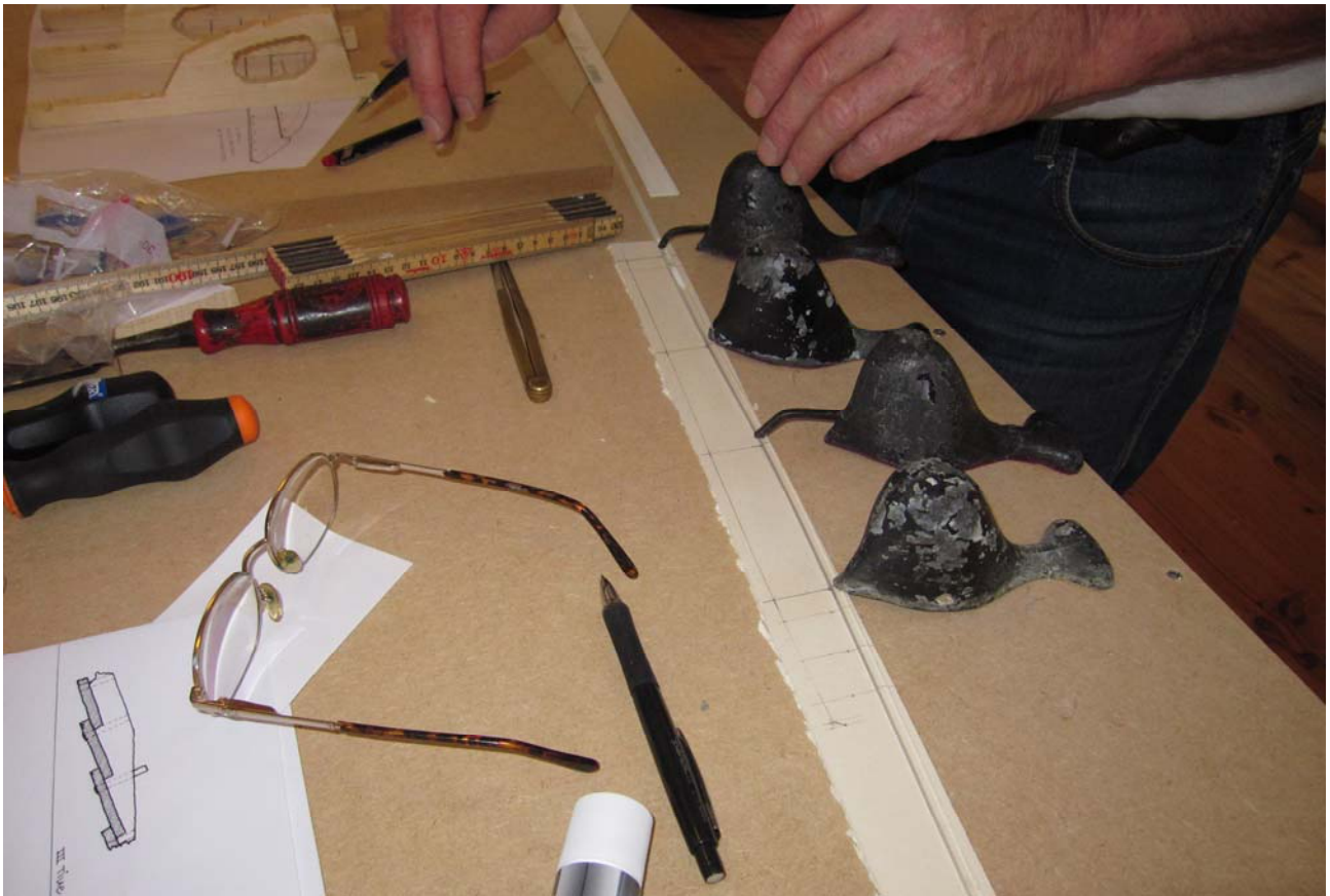
En trækstok af nylon bruges til at forbinde de afmærkede punkter, så der kan trækkes en streg.
