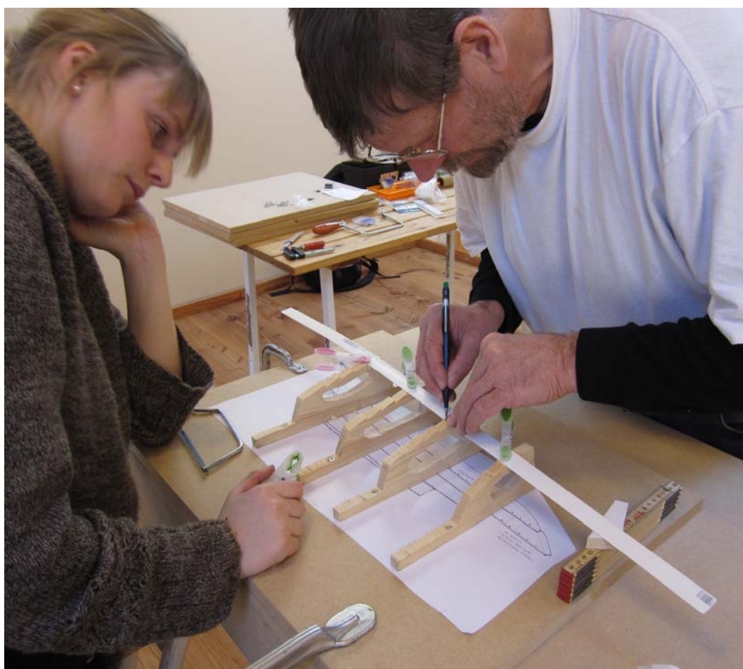
Vragdel 5's krumninger viser sig efterhånden som bordenes anlægsflader bliver stukket til og angiver bordforløbets tredje dimension.
