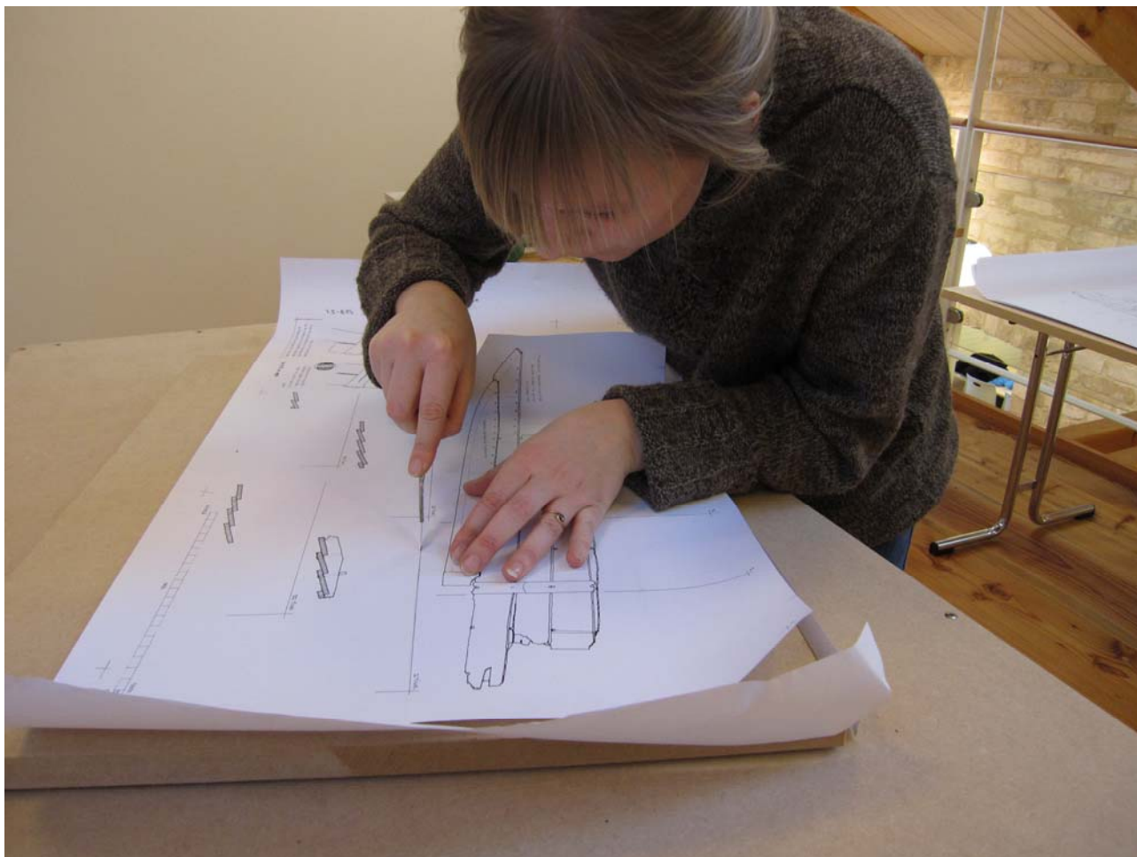
Spejlvendt tegning af vragdel 5 skæres ud for at blive limet på byggebeddingen.
