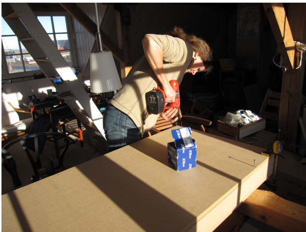
Byggebeddingen skrues sammen som en lav kasse for at sikre et stabilt plan, hvorfra vragedelen kan bygges op svarende til det plan, hvorfra der blev målt ned til den ilanddrevne vragedel.
