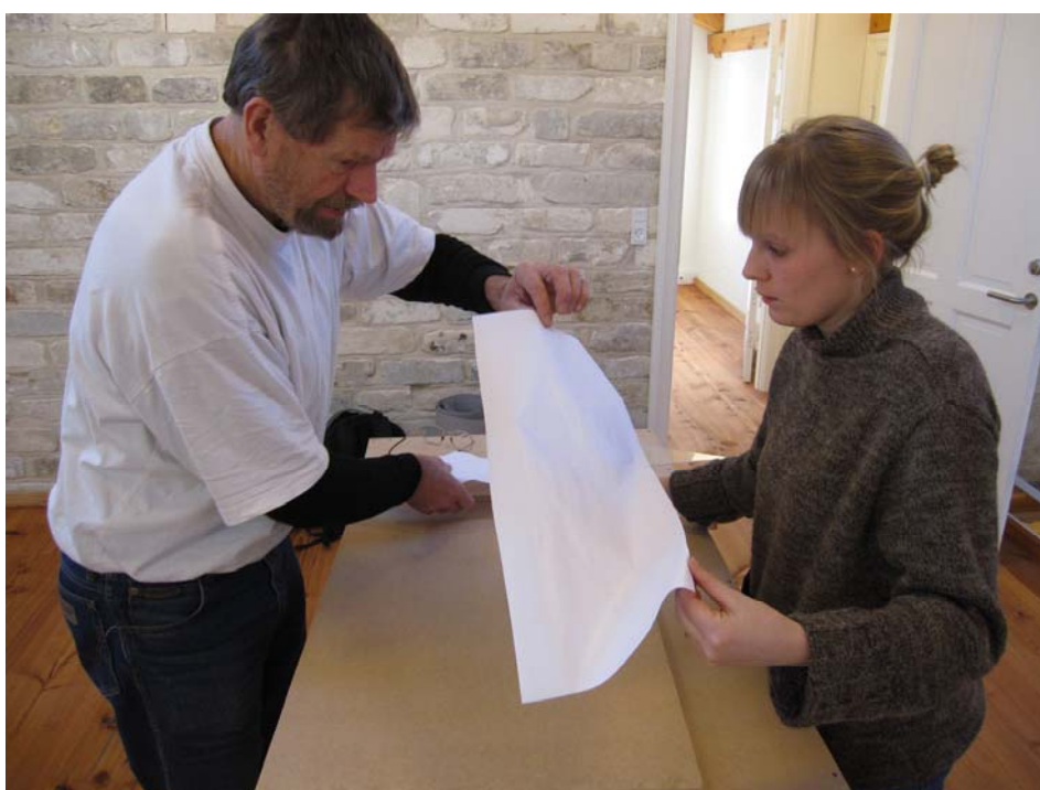
Spejlvendt tegning af vragdel 5 skæres ud for at blive limet på byggebeddingen.
