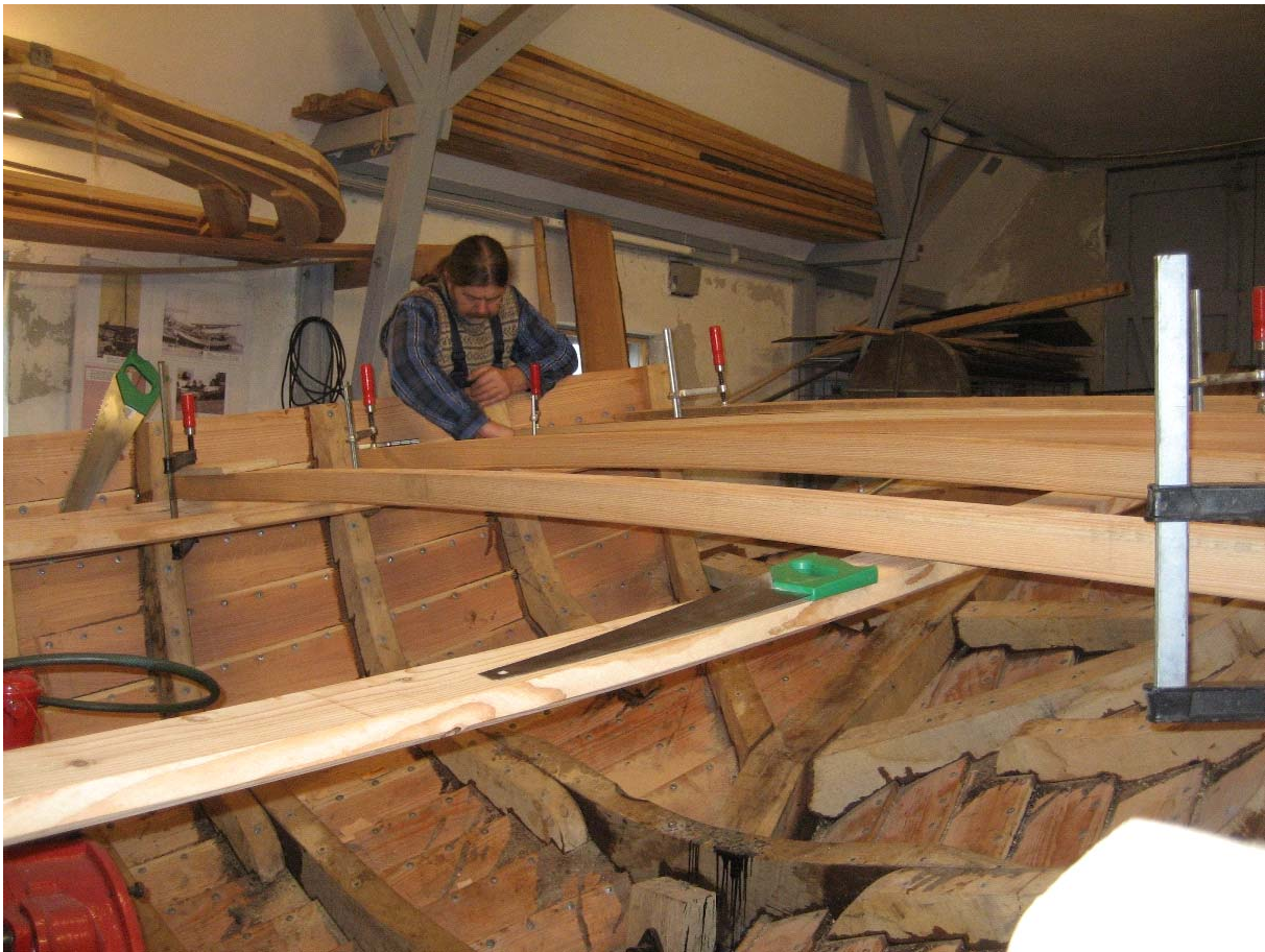
Dæksbjælkerne på Jammerbugt er sat fast, og endnu er det muligt at se indretningen af båden lidt fra oven. Foto: Pipsen
