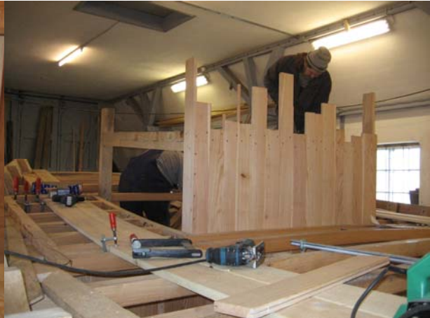
Motorruffet bygges op i lærkebrædder. Foto: Pipsen
