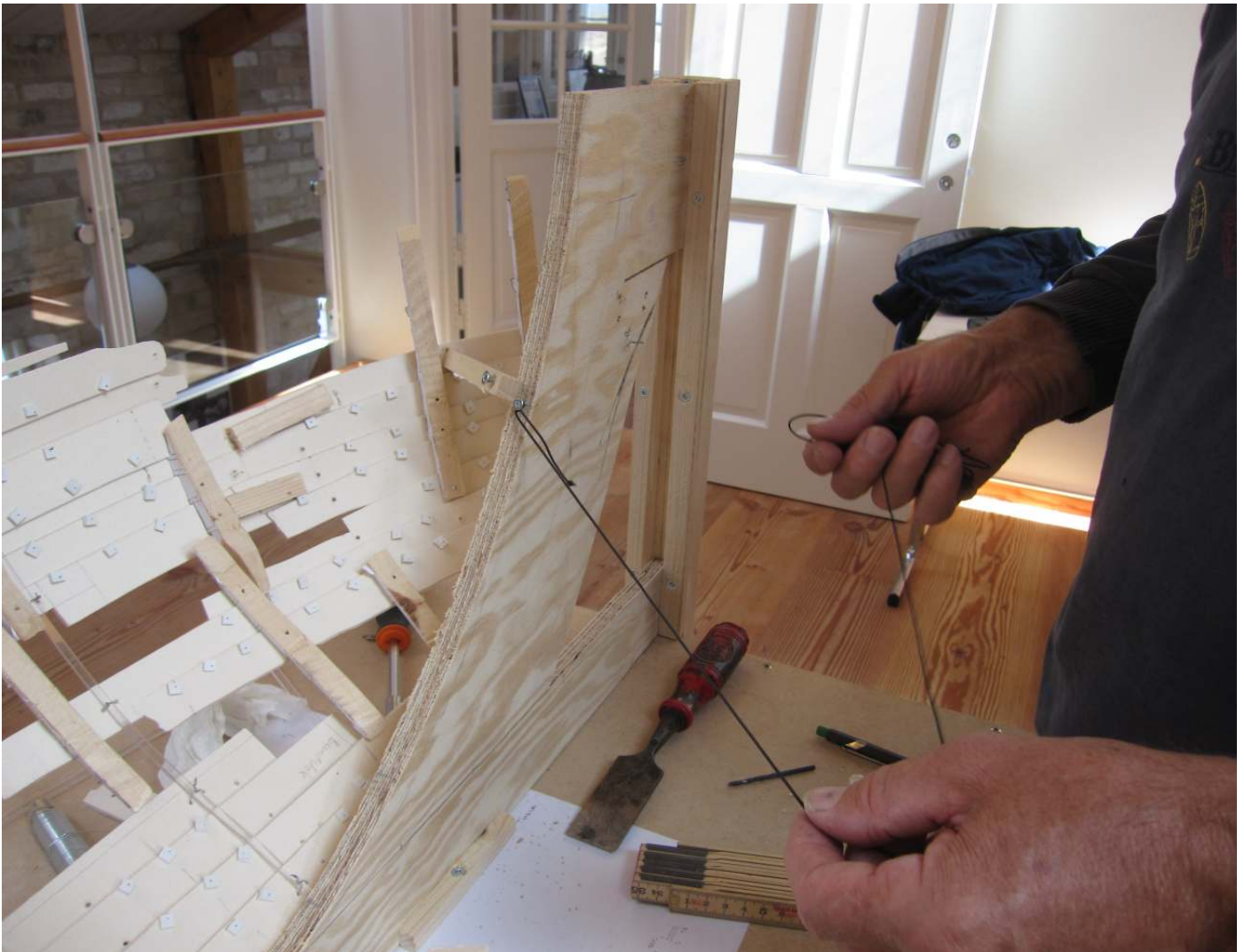
Snor til angivelse af centerplanets grænse mellem styrbord og bagbord side af skibet gøres fast i forstævnen.
