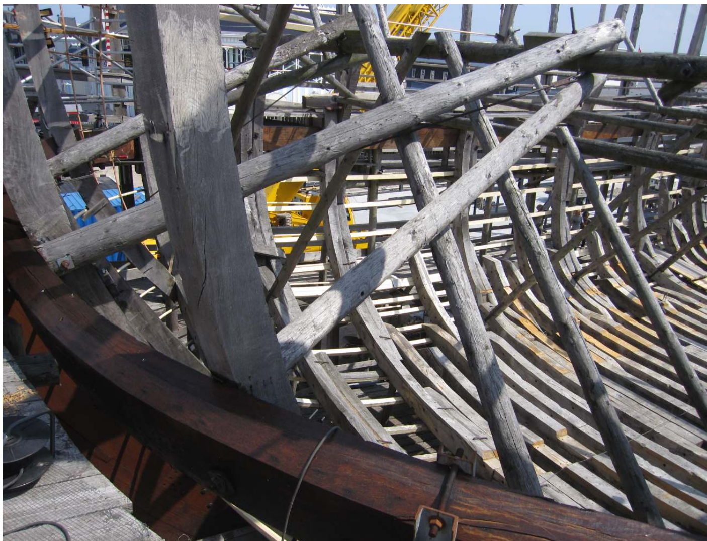
Trykstokke til bovbordenes krumning, som de kan ses anvendt under den aktuelle bygning af "'Zeven Provinciën' (De syv provinser) på Bataviaværftet uden for Amsterdam.
