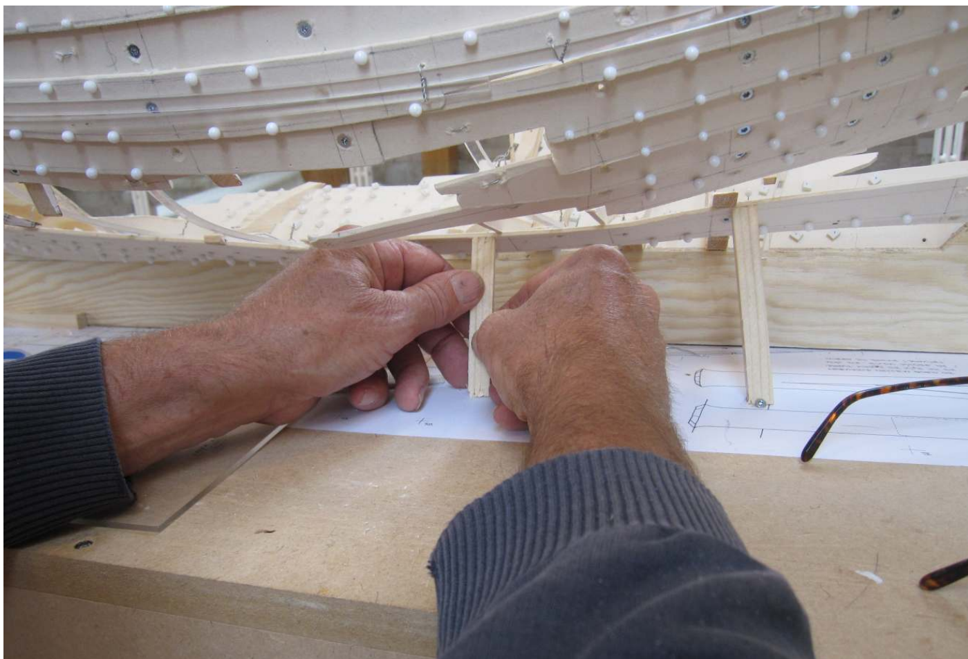
Stiveren skubbes ind, til den klemmer bordet og en papkopi af tredje bundstok agterfra op til den nivellerede højde.
