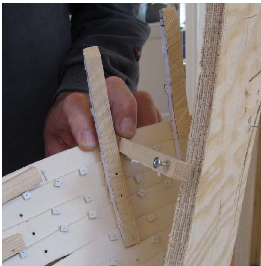
Trykstokke til bovbordenes krumning, som de kan ses anvendt under den aktuelle bygning af "'Zeven Provinciën' (De syv provinser) på Bataviaværftet uden for Amsterdam.
