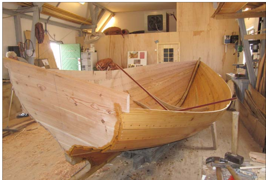
Henrik Sonnes snare (klitmøllerjolle) er bordklædt i det gamle redningshus, og han er ved at give linolie. Foto: Pipsen
