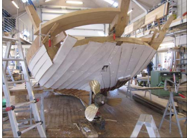
Nordvest har fået første gang hvid linoliemaling på fribordet. Foto: Pipsen
