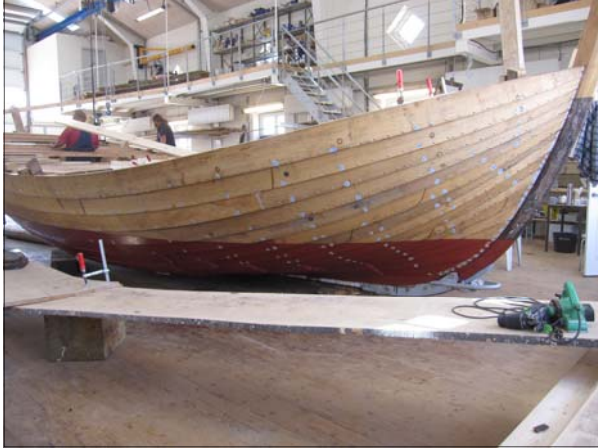
Nordvest bordklædt med dæksbjælker og bundmalet første gang. Foto: Pipsen
