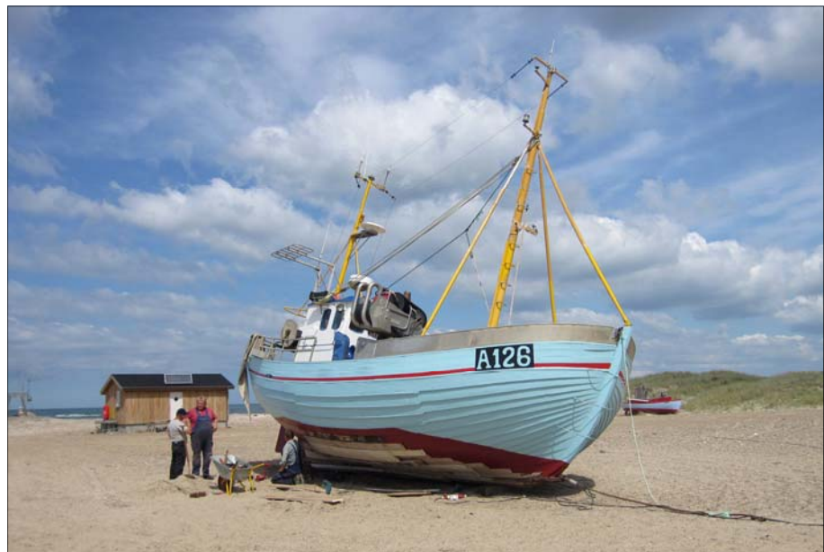
Hebron er blevet malet, og slidbunden er ved at blive skiftet. Foto: Pipsen
