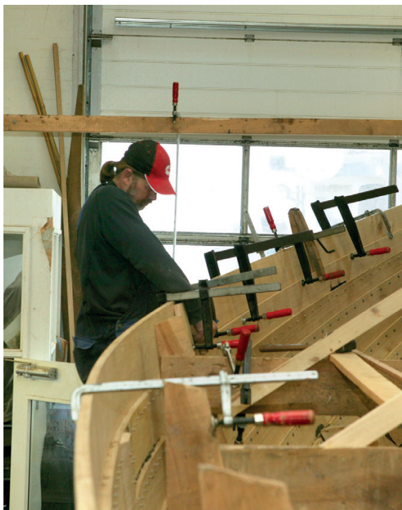
Peter er ved at sætte sidste bordgang op i bagbords side.
