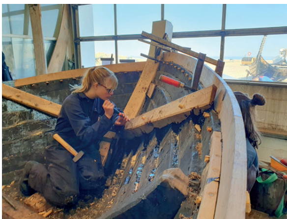
En trænagle drilledes og måtte ud igen. På indersiden sættes en kile igennem, og tilsidst saves nagle glat med bordet. Foto: Pipsen
