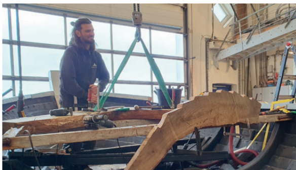
René er i gang med bovbåndet, der skal sidde forrest i skibet og være med til at gøre skibet stærkt. Foto: Pipsen
