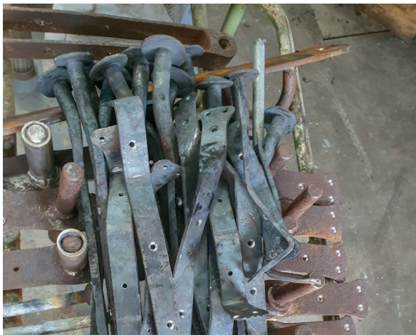
De håndsmede bolte der nu skal galvaniseres. Foto: Pipsen
