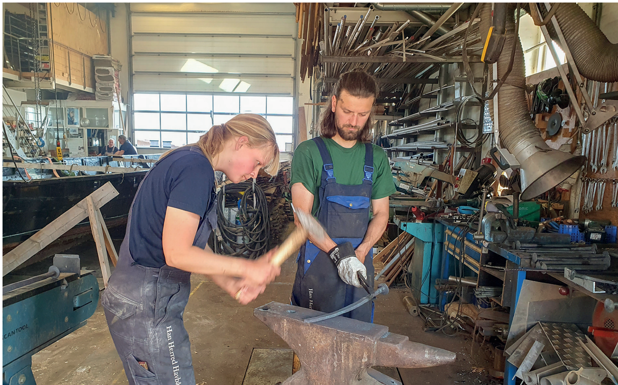
Alle har været med til at smede boltene. Her er det René, der holder, og Anika der hamrer jernet fladt. Foto: Pipsen
