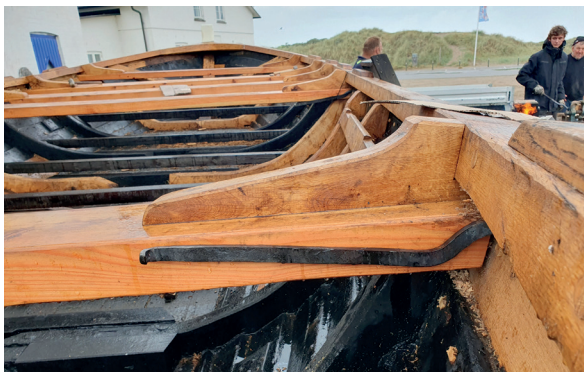
Boltene bliver tilpasset det sted, hvor de skal sidde. Foto: Pipsen
