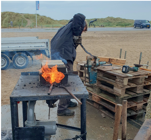
Boltene opvarmes, så de kan bukke i facon. Foto: Pipsen
