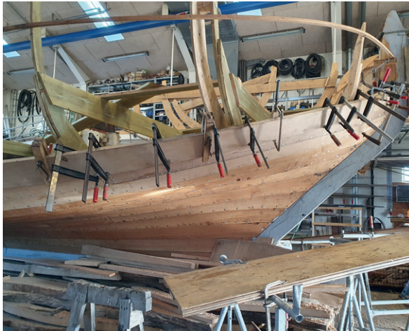
Især rundingen af bordene og dermed faconen ude agter er en udfordring at lave. Foto: Pipsen
